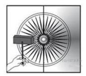
Велосипедное колесо, у которого вместо металлических спиц обод удерживают натянутые резинки, установлено в вертикальной плоскости и может свободно вращаться вокруг своей горизонтальной оси, зажатой в штативе. К неподвижному колесу подносят слева мощную лампу и начинают нагревать резиновые «спицы» (см. рис.). Резина, в отличие от металла, при нагревании не расширяется, а сжимается. Опишите, опираясь на известные физические законы, что будет происходить с резинками, и как колесо будет двигаться.
