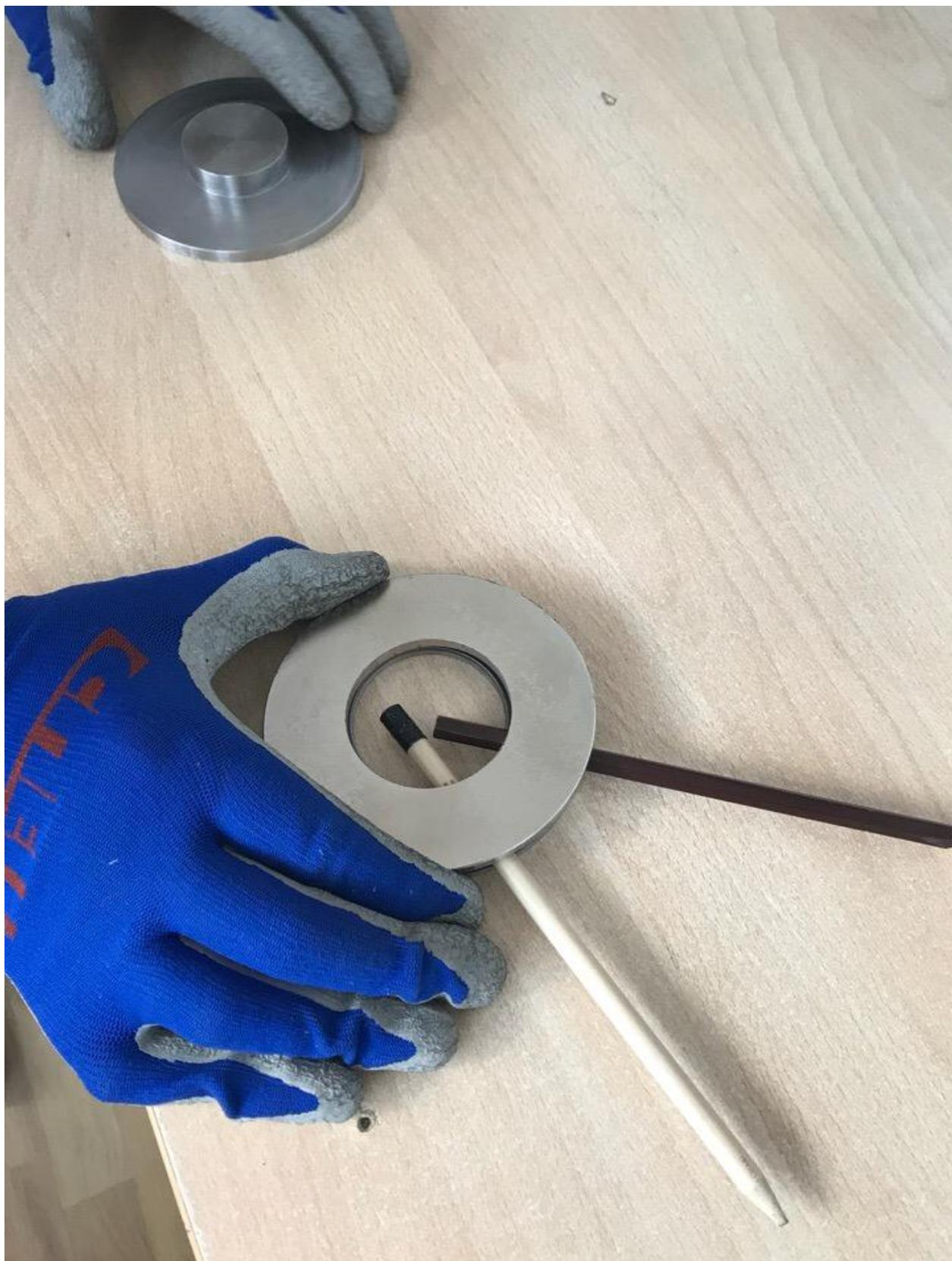
Рисунок 10 – Подготовка поверхностей магнитопровода и магнита к сцеплению
