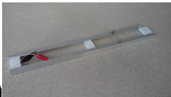
Такая модель была найдена в журнале по физике. Ртутный контакт в этой схеме заменен неподвижными алюминиевыми рельсами, а в качестве ротора используется не один диск, а пара неодимовых магнитов, насаженных на одну ось. Неодимовые магниты используются потому что они проводят электрический ток. Когда по системе рельсы – шасси течет ток, то при его
