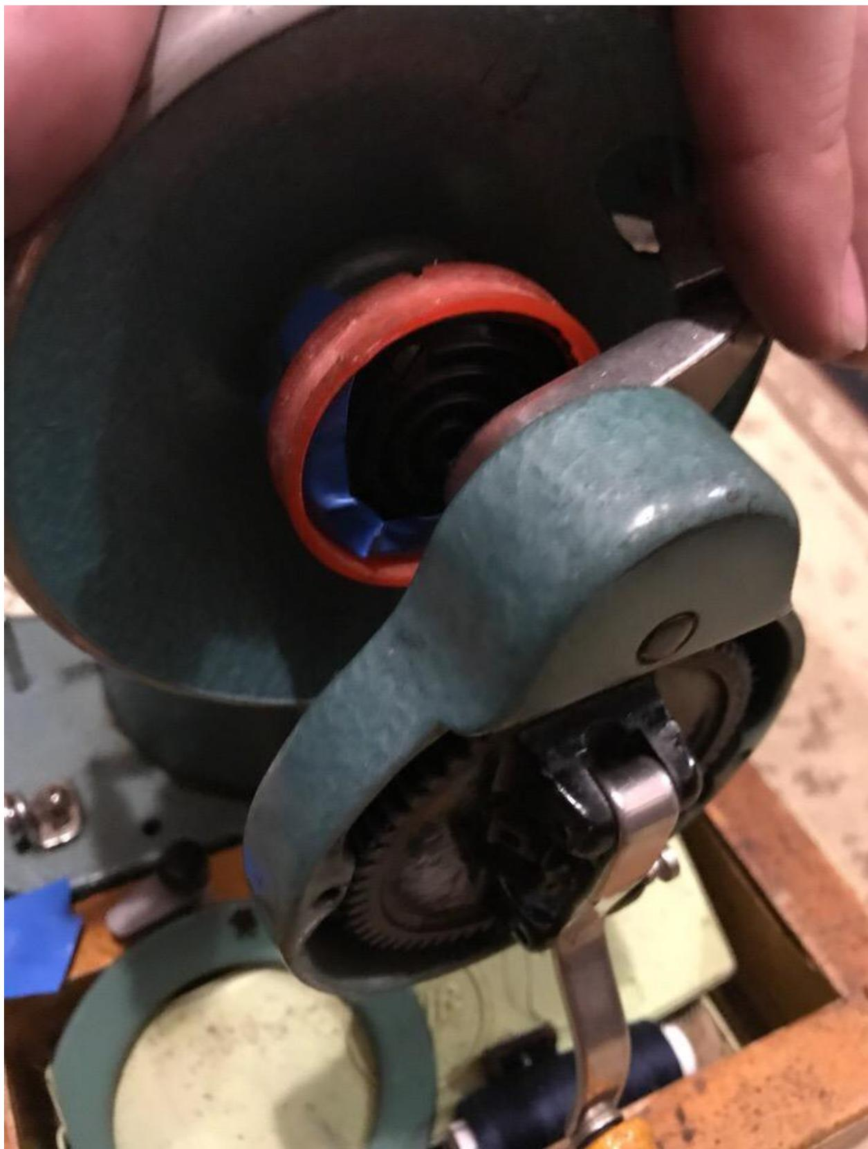
Рисунок 13 – Намотка катушки при помощи махового колеса швейной машинки
