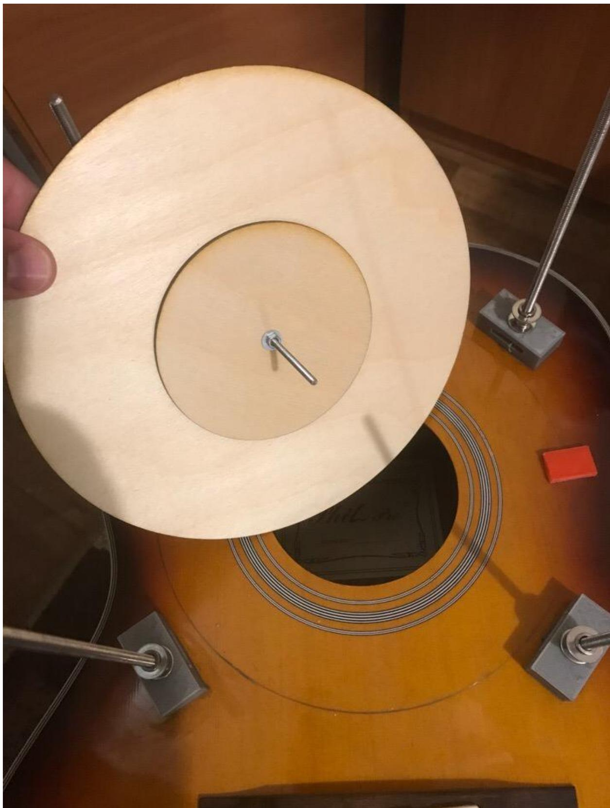
Рисунок 20 – Разметка резонатора для последующего закрепления на нем основной конструкции
