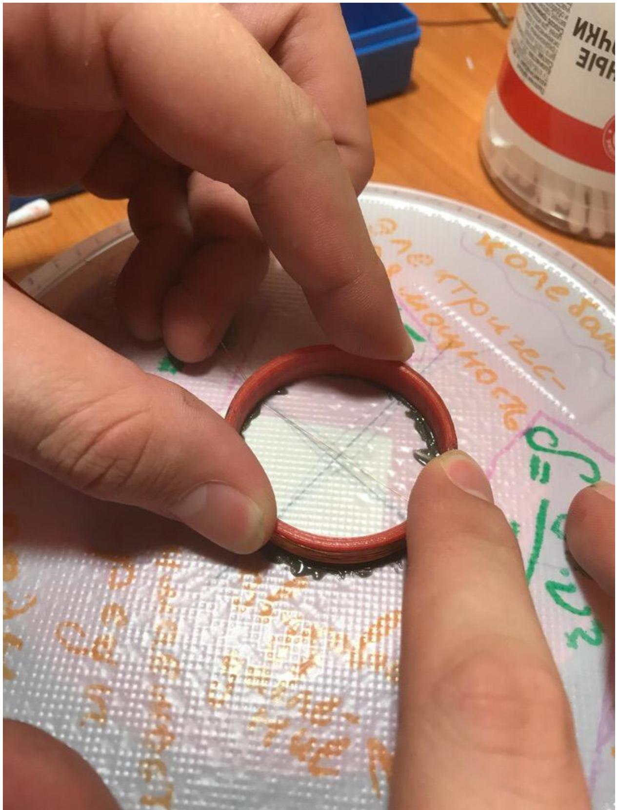
Рисунок 19 – Закрепление якоря на диффузоре. Центровка
