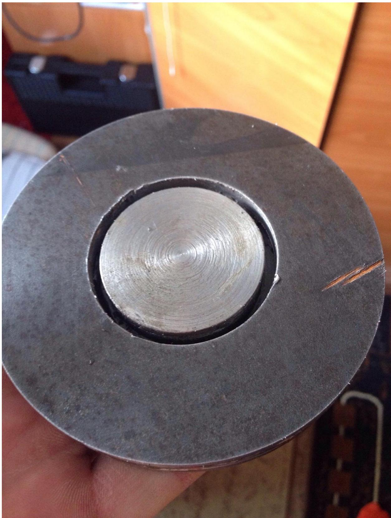
Рисунок 12 – Установленный полюсный наконечник
