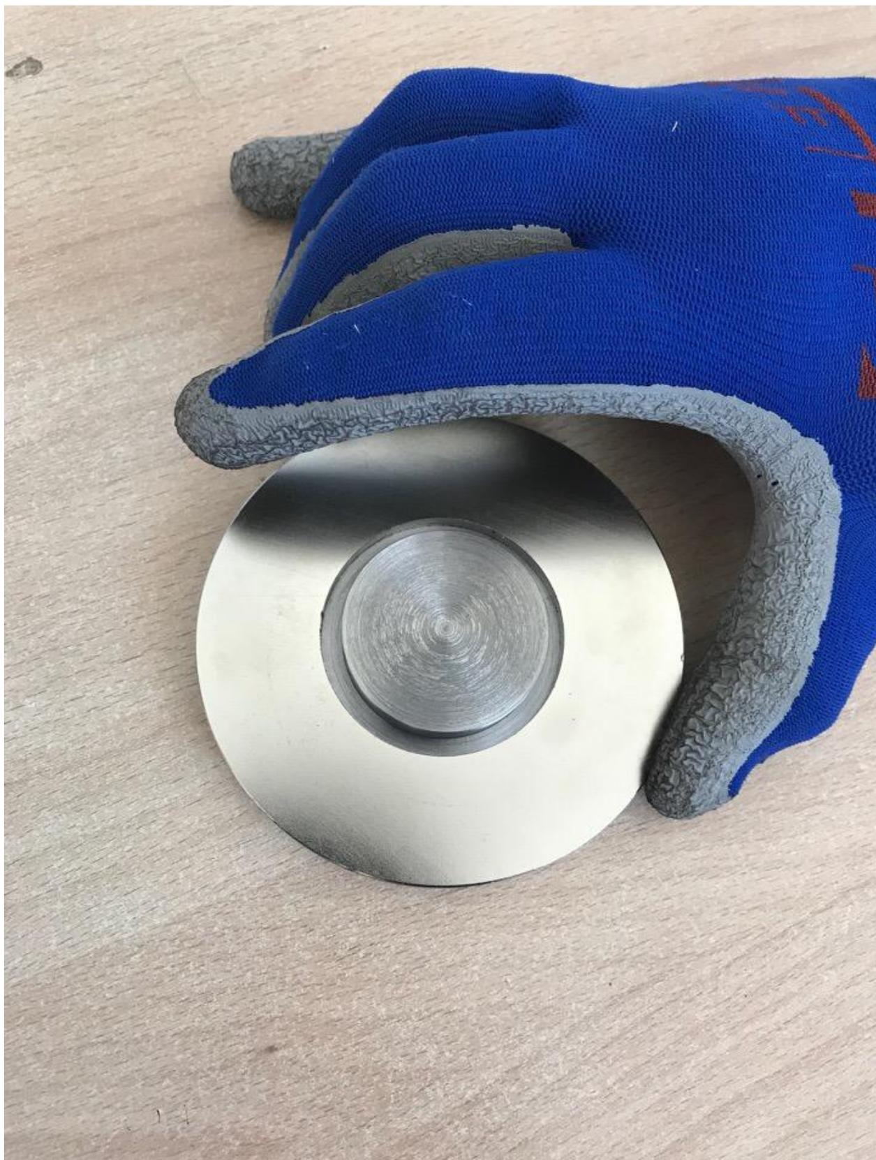
Рисунок 11 – Центровка магнита относительно магнитопровода
