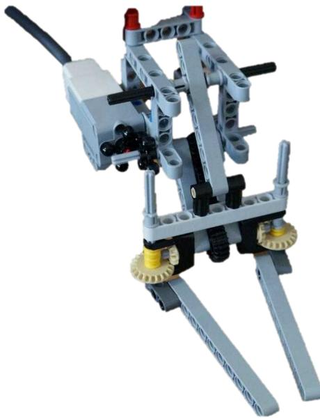
*Рис. 5. Механизм захвата солнечных панелей и деревьев*
